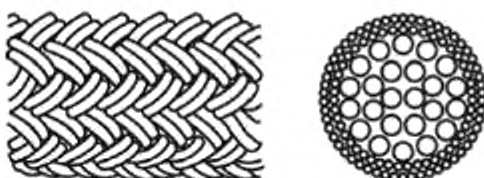
Рисунок 1 — Конфигурация каната двойного плетения и каната двойного плетения повышенной прочности из полиамидных волокон
